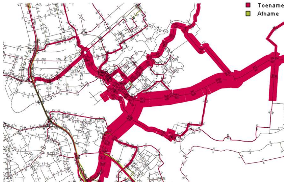
Figuur 2 de verschillen in intensiteiten tussen scenario F met en zonder gebiedsbod (exclusief overeenkomstige intensiteiten)
